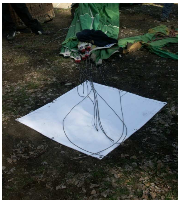
Rys. 2. Na pierwszym planie 10 z 12 linek nośnych powłoki upalonych po kolizji z linią elektryczną. W głębi zdjęcia widoczne uszkodzenia fartucha.
