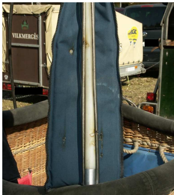
Rys 3. Uszkodzenia linek kosza, wspornika palnika i osłony, spowodowane przeskokiem iskry elektrycznej.
