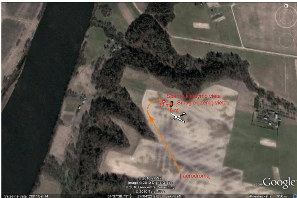
3 pav. Sklandytuvo LAK-12 LY-GDI tūpimo schema
