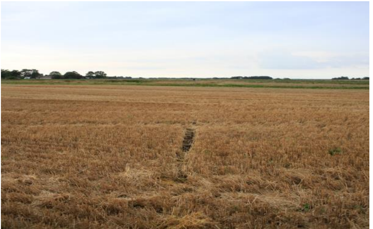
6 pav. Dešiniojo pagrindinio rato paliktas pėdsakas po pirmojo kontakto su žeme.
