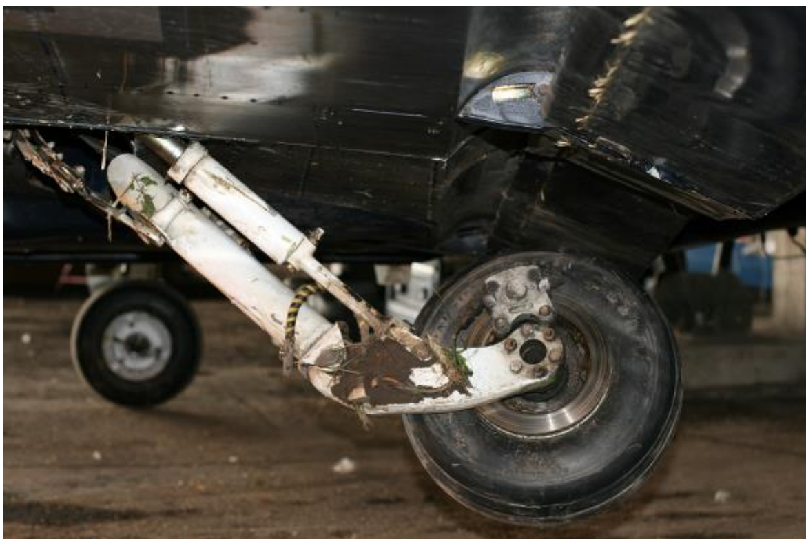
2 pav. Nulūžusi kairioji pagrindinė važiuoklės atrama.
