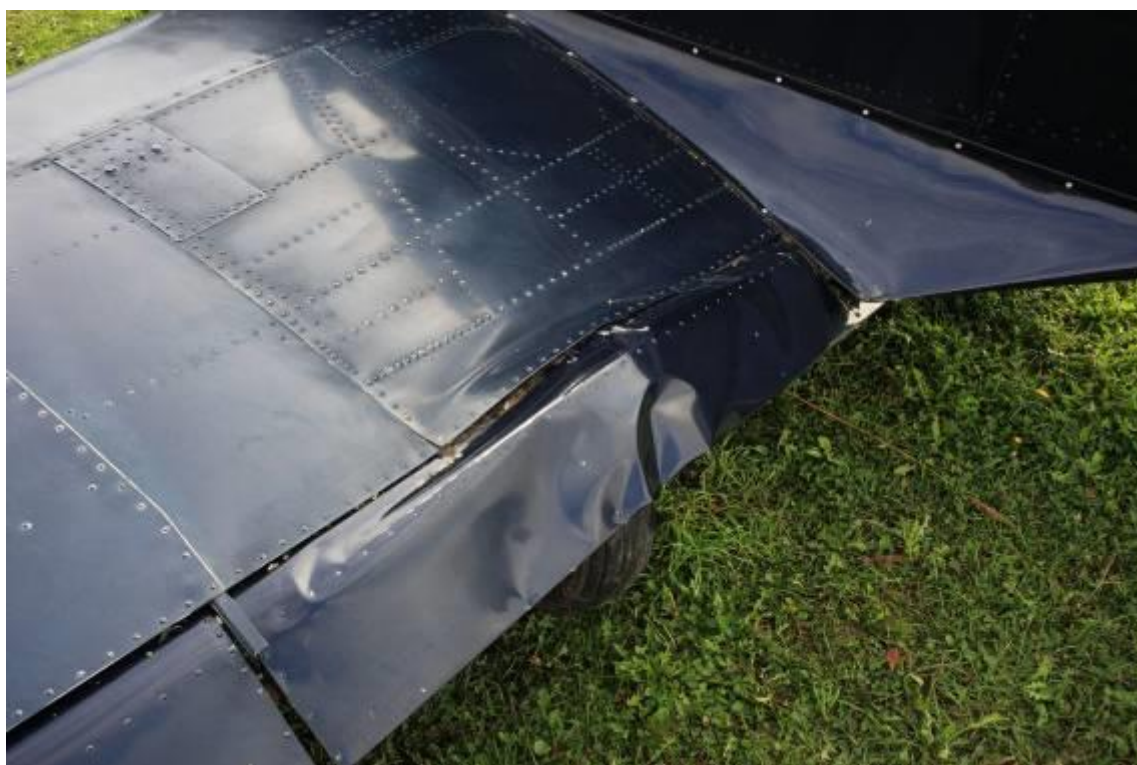
4 pav. Kairiojo užsparnio ir galinės sparno briaunos pažeidimai.
