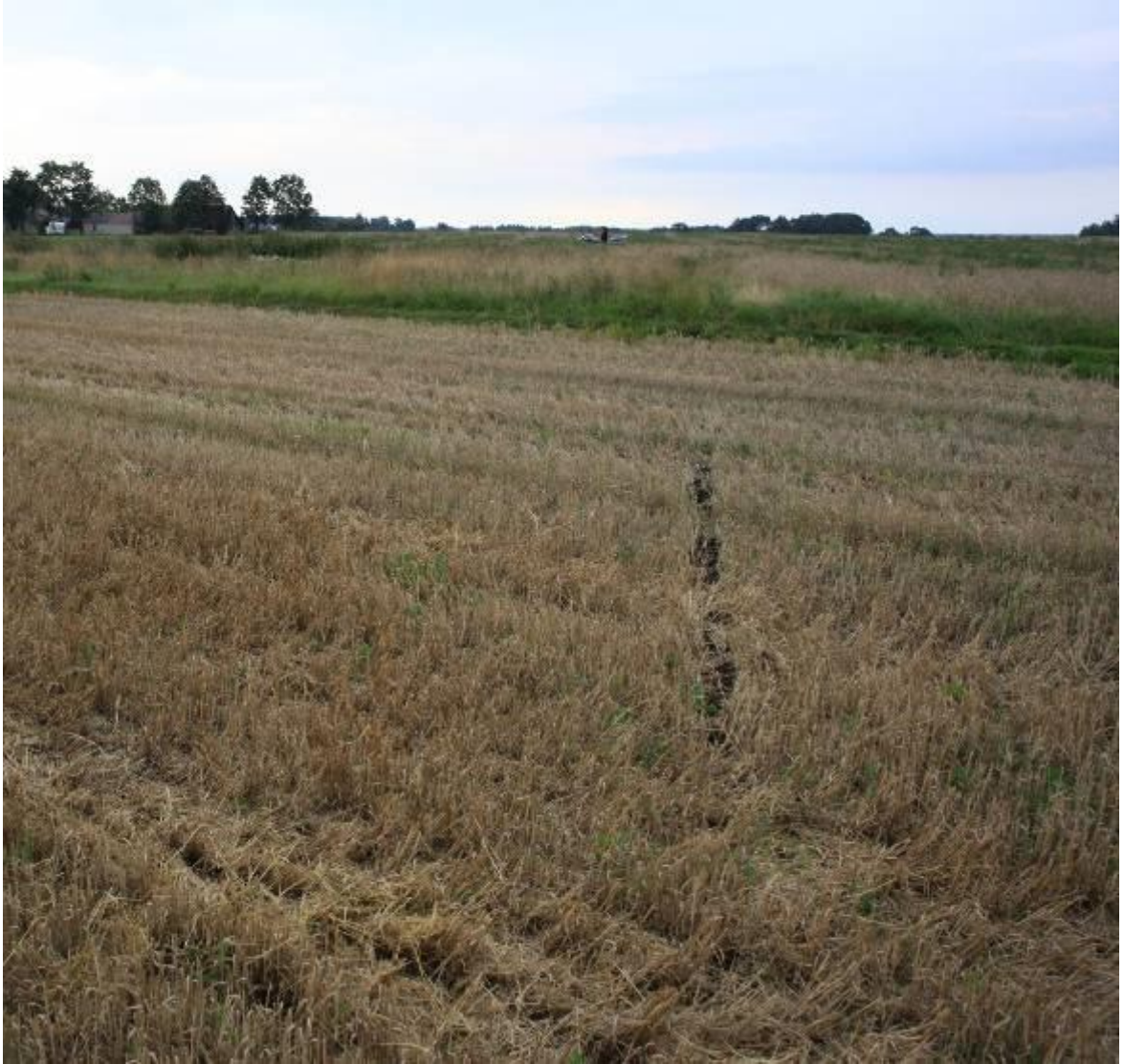
7 pav. Dešiniojo pagrindinio rato paliktas pėdsakas po antrojo kontakto su žeme.
