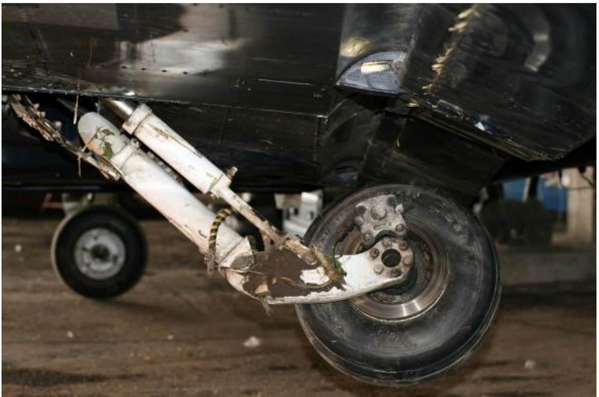
2 pav. Nulūžusi kairioji pagrindinė važiuoklės atrama.
