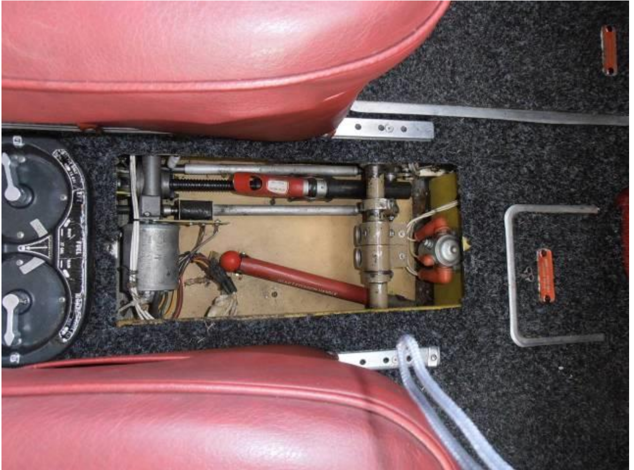
10 pav. Lėktuvo „Piper PA-30 TWIN Comanche“ važiuoklės įtraukimo-išleidimo mechanizmo pavara ir elektros motoras iškart po avarijos.
