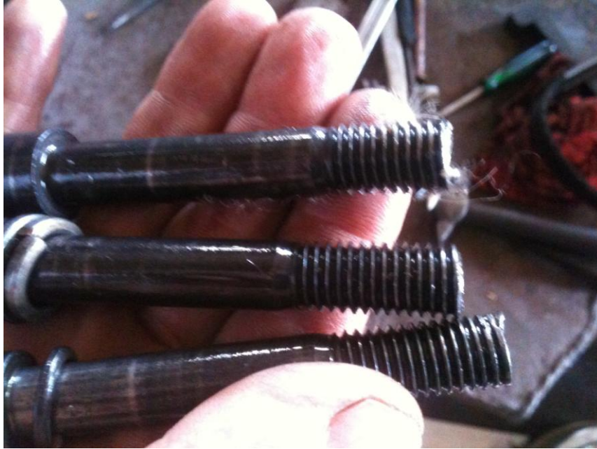
4 pav. Atsisukę varžtai iš reduktoriaus.
