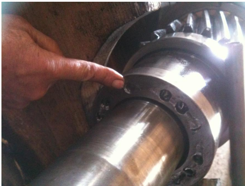
5 pav. Nupjautų smeigių ir važtų tvirtinimo vieta reduktoriuje.
