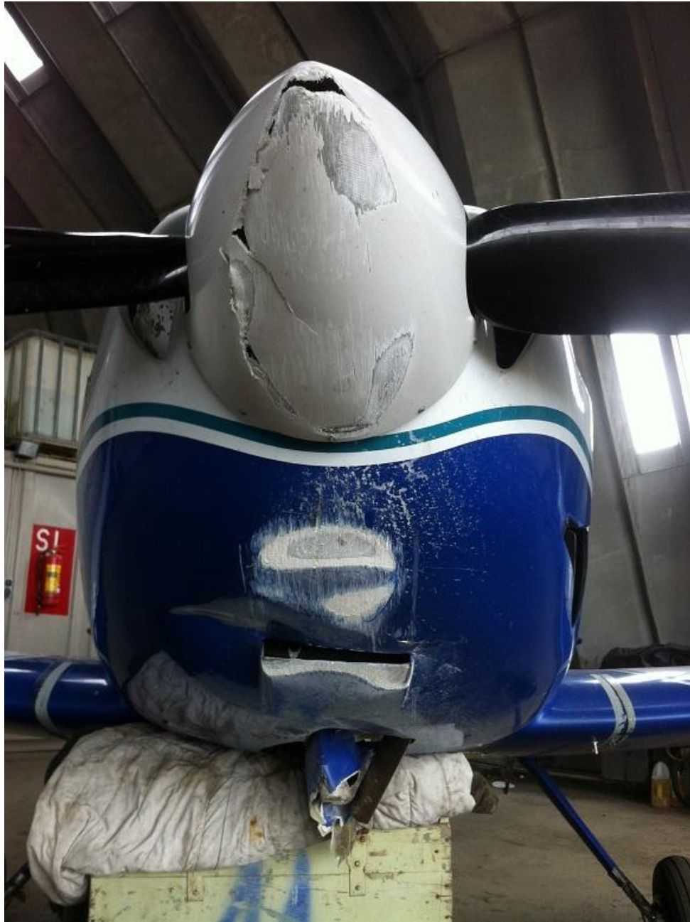
5 pav. Lėktuvo „Impulse 100“ apatinio variklio kapoto ir propelerio stebulės aptako pažeidimai.
