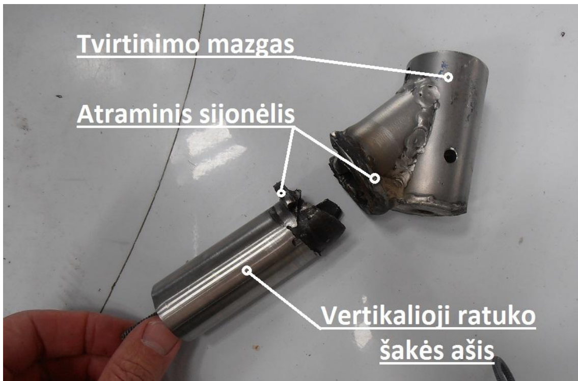
6 pav. Sulūžęs priekinio ratuko šakės tvirtinimo mazgas.
