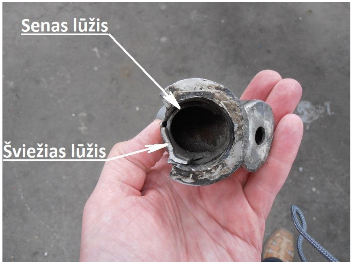
7 pav. Ratuko šakės ašies vertikaliosios ašies lūžio vieta.
