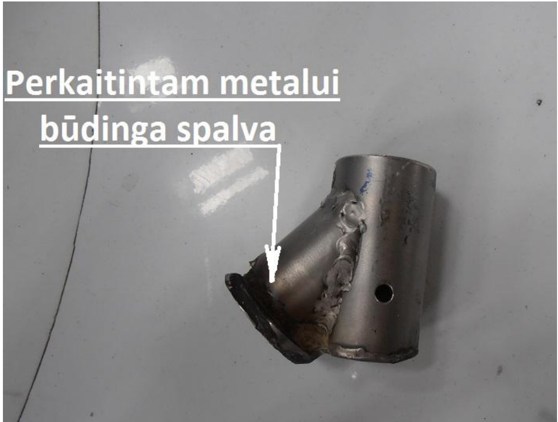
8 pav. Priekinio rato tvirtinimo mazgo perkaitinta zona.
