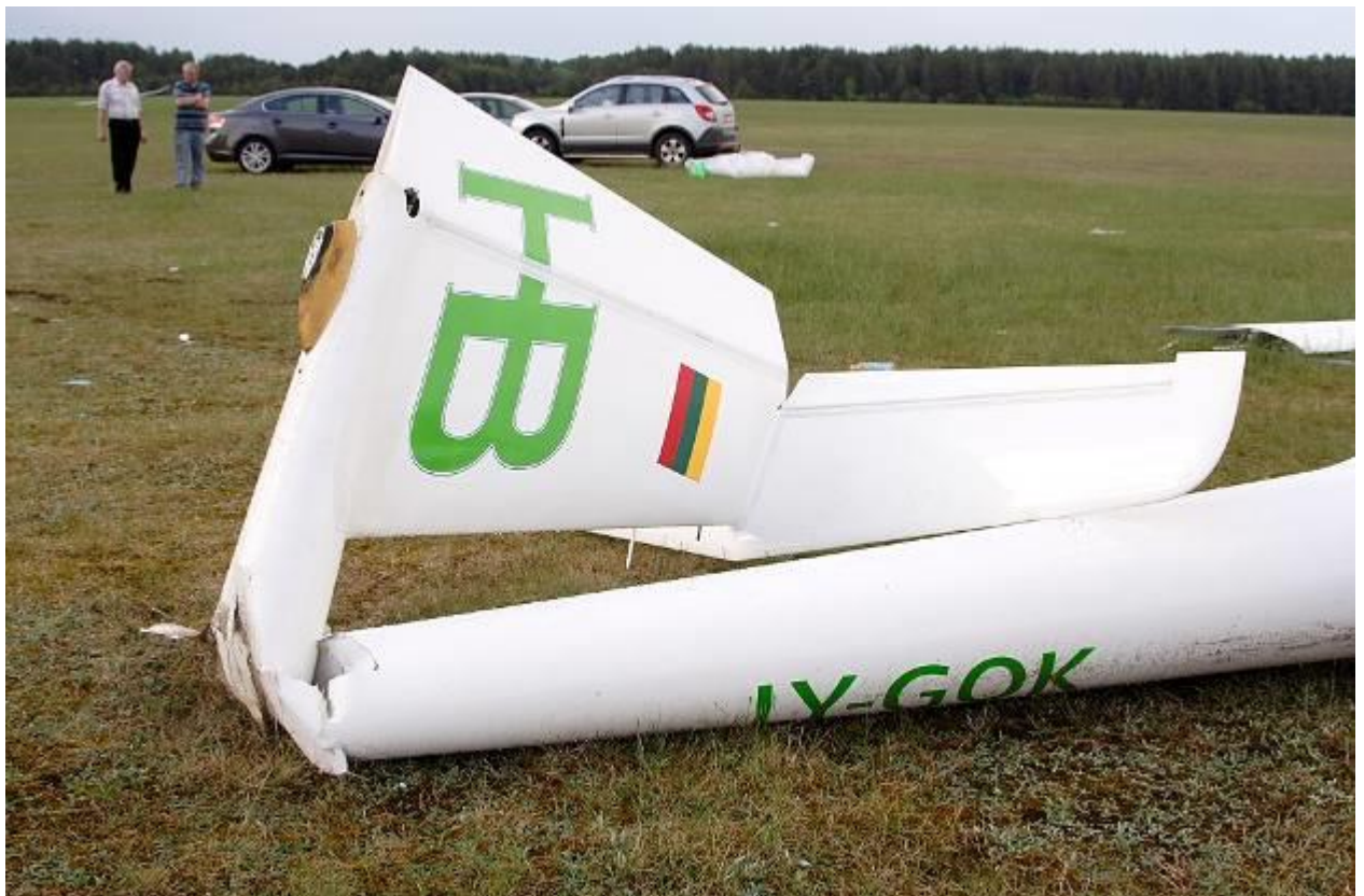
5 pav. Nulūžusi liemens galinė dalis su kiliu ir stabilizatoriumi.
