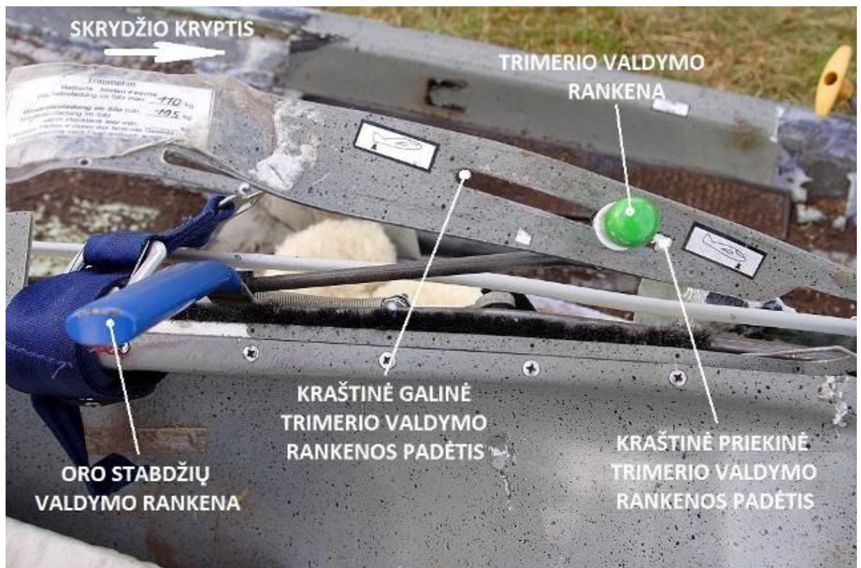
10 pav. Aukščio vairo trimerio valdymo rankenos padėtis iškart po avarijos (vaizdas į kairiąją kabinos pusę).
