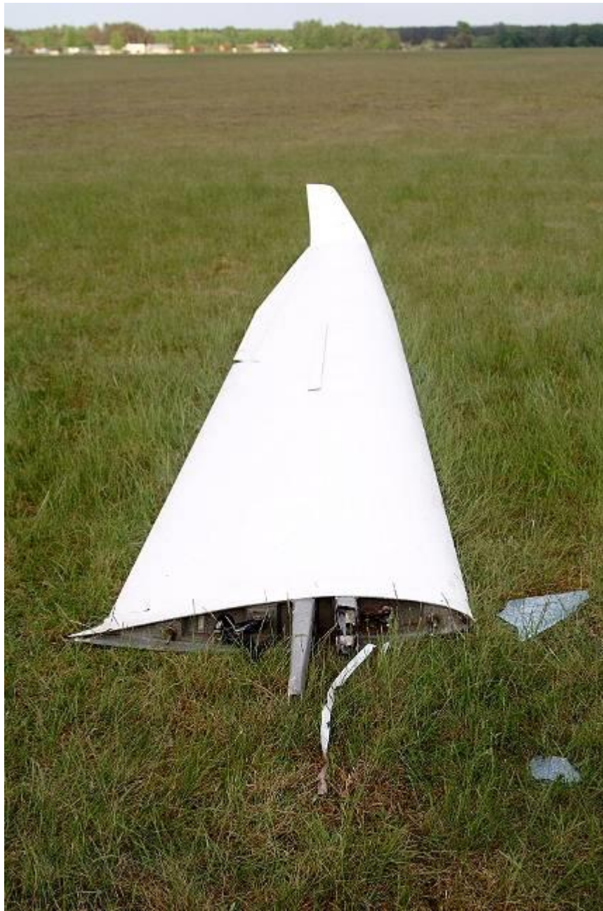
6 pav. Kairioji sparno pusė. Priekyje matyti nulūžęs lonžeronas sparno pusių sujungimo zonoje.
