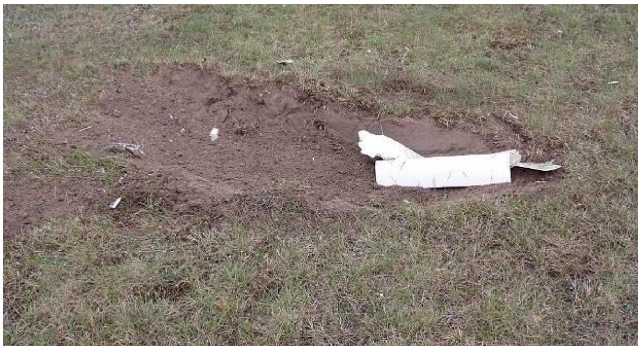
8 pav. Pagrindinio smūgio vietoje likusi duobė ir joje gulinčios važiuoklės drelės su liemens kevalo fragmentu.
