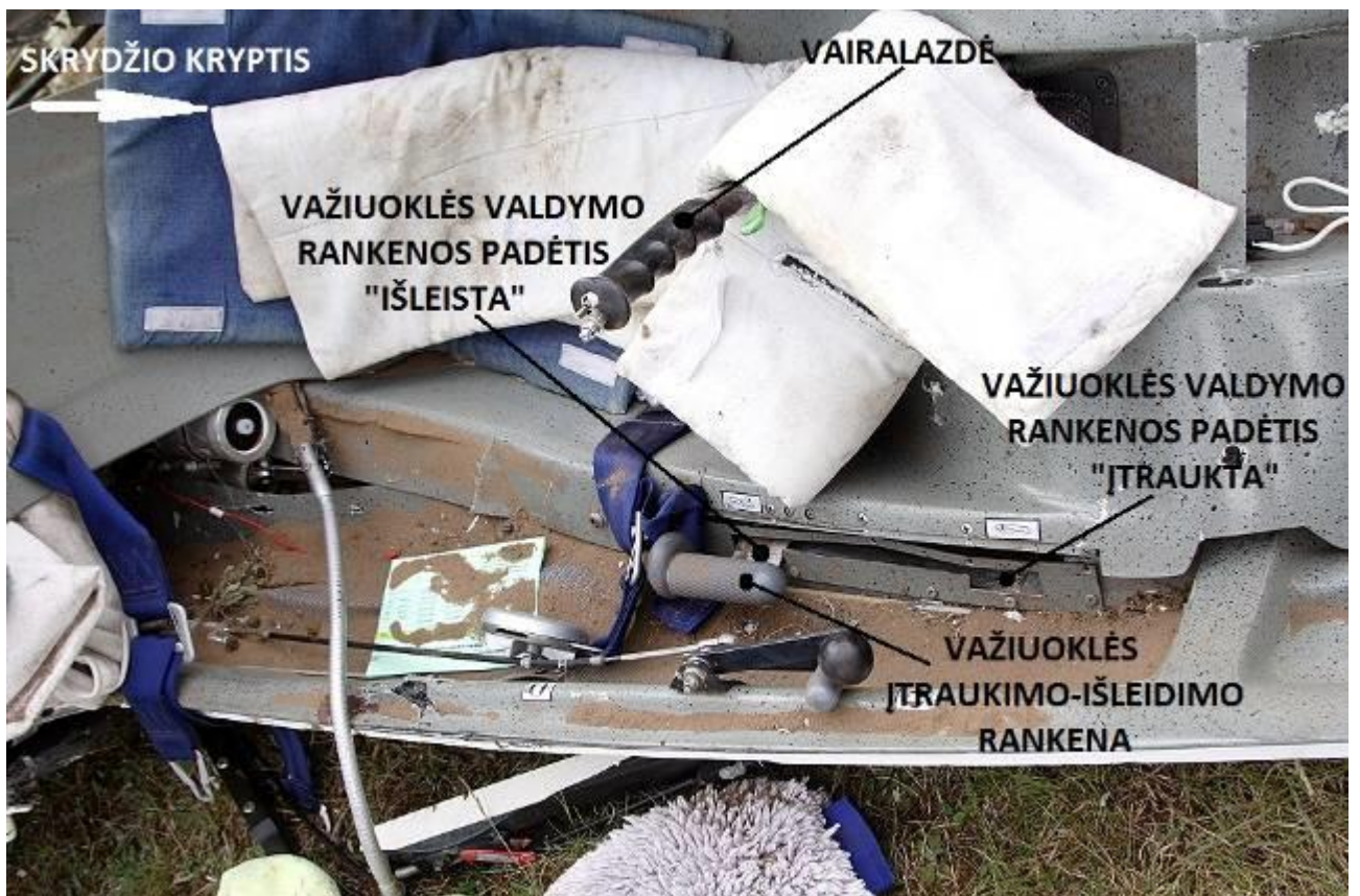
11 pav. Važiuklės įtraukimo–išleidimo rankenos padėtis iškart po avarijos (vaizdas į dešiniąją kabinos pusę).
