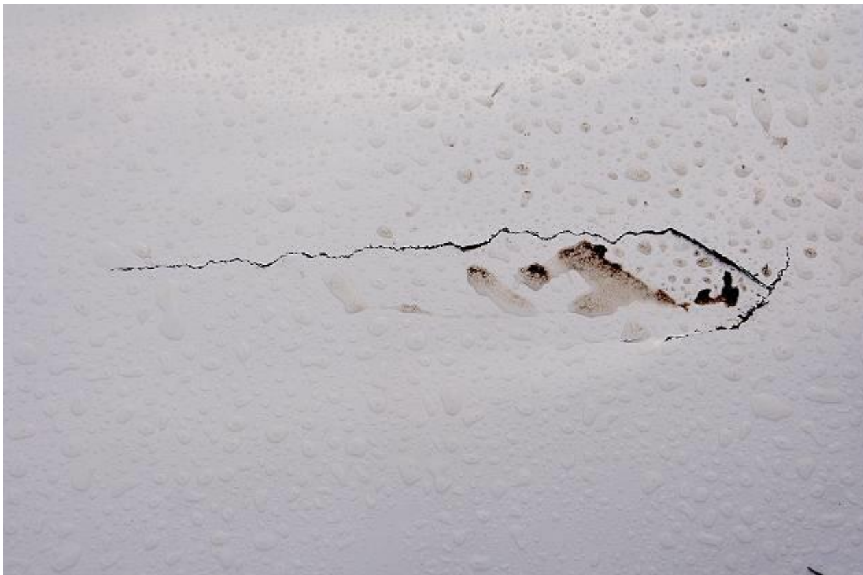
7 pav. Įtrūkimas dešinėsios sparno pusės viršutiniame kevale.
