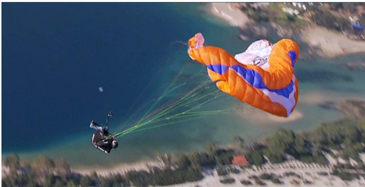
4 pav. Parasparnis nutrūkus oro srautui nuo sparno (nuotrauka iš interneto).
