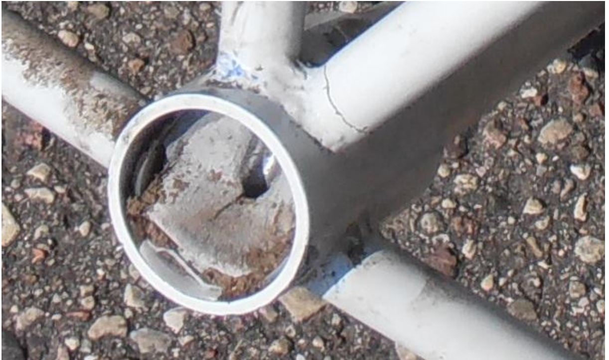
11 pav. Priekinės važiuoklės atramos lingės dalis likusi variklio tvirtinimo rėme.
