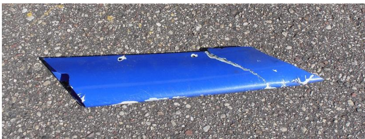
6 pav. Pažeistas priekinės važiuoklės lingės aptakas.
