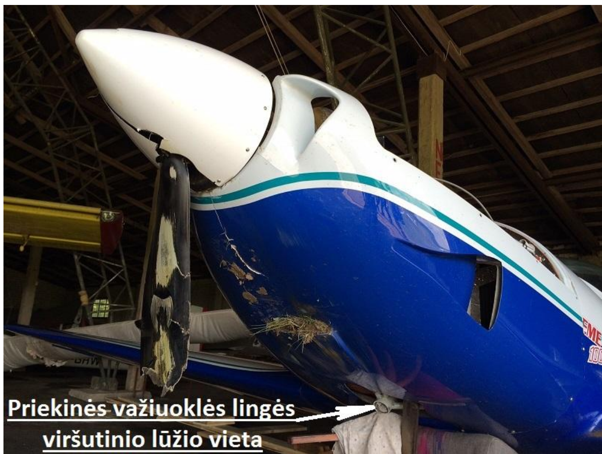
7 pav. Propelerio, apatinio variklio kapoto pažeidimai ir viršutinio priekinės važiuoklės lingės lūžio vieta.
