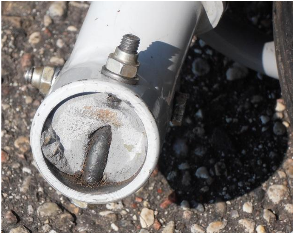
9 pav. Apatinės priekinės važiuoklės atramos lingės dalis likusi ratuko tvirtinimo įvorėje.
