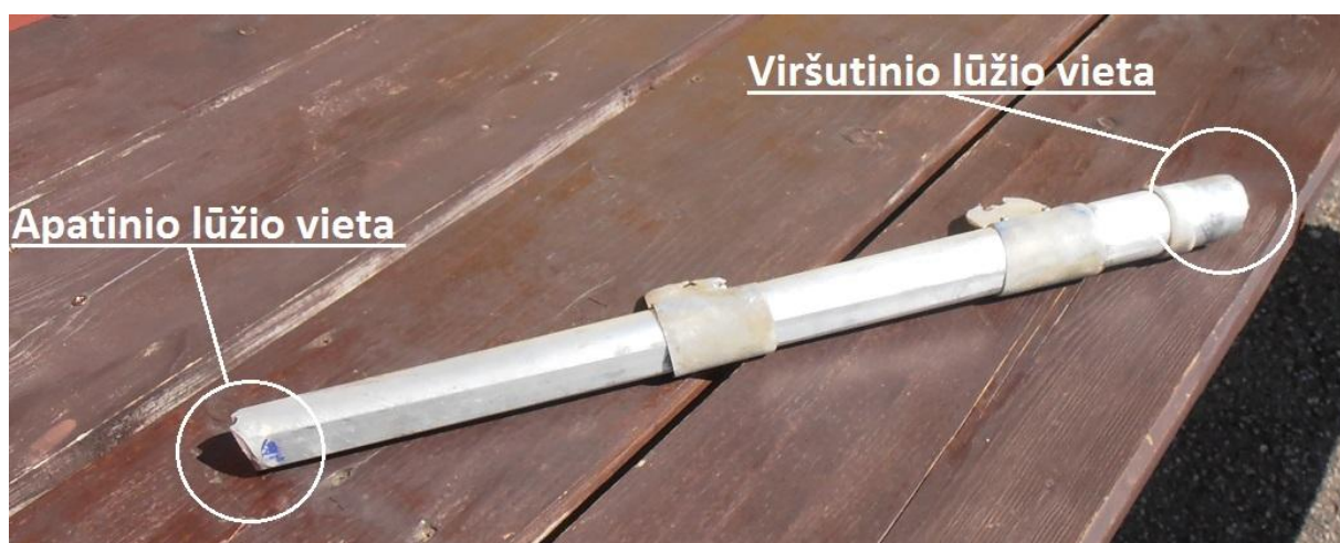
3 pav. Iš abiejų galų nulūžusi priekinės važiuoklės lingė.
