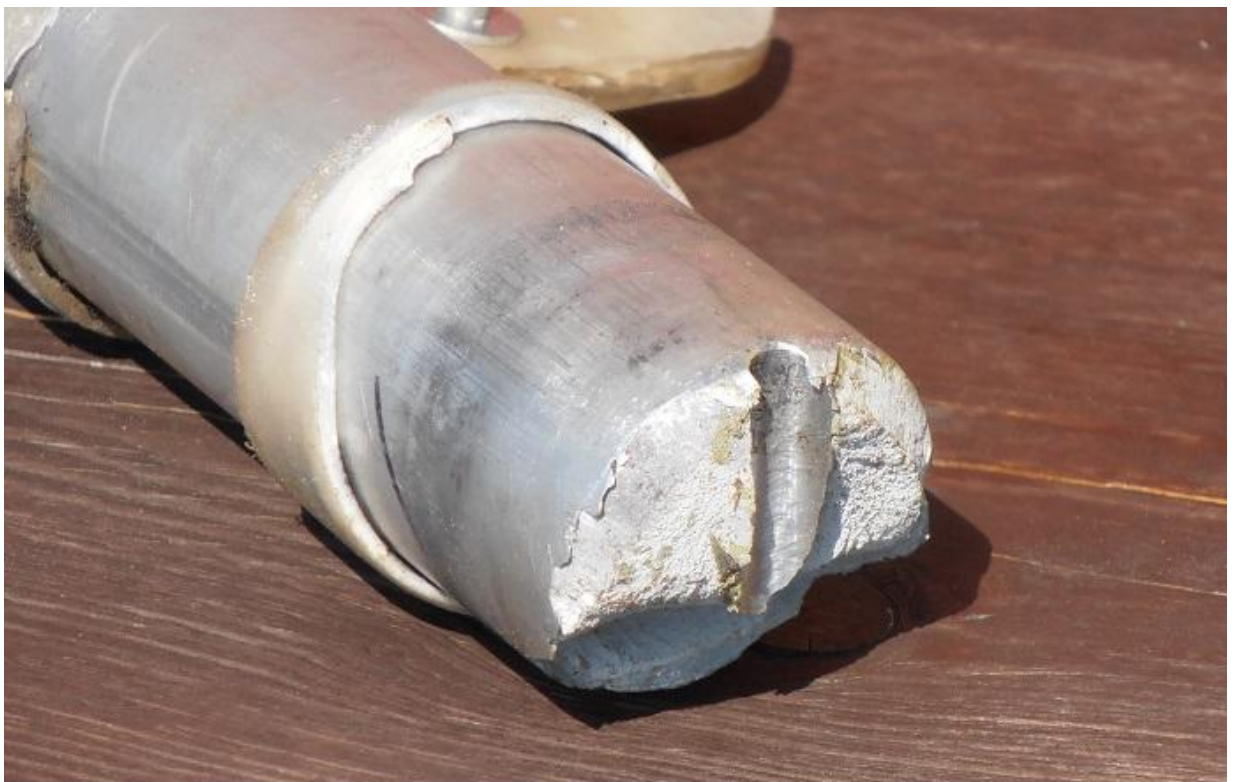
10 pav. Viršutinio priekinės važiuoklės atramos lingės lūžio vieta.
