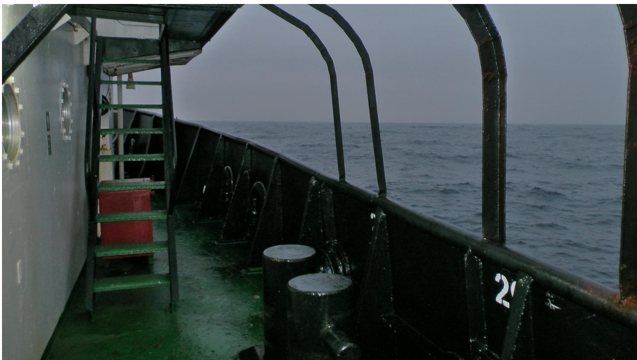
3 pav. Matomas standartinis laivo borto aukštis nuo laivo pagrindinio denio.
