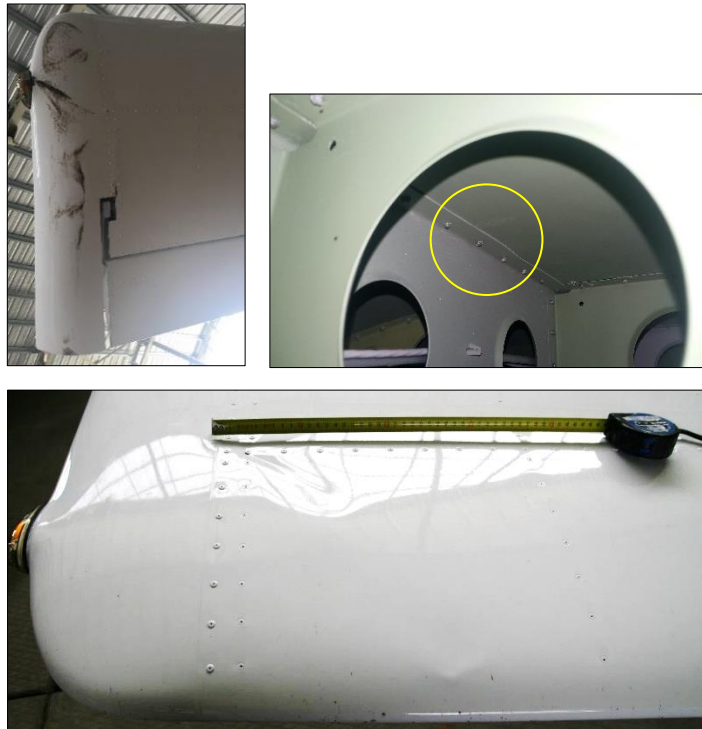
2 pav. Lėktuvo sparno konstrukcijos pažeidimai
